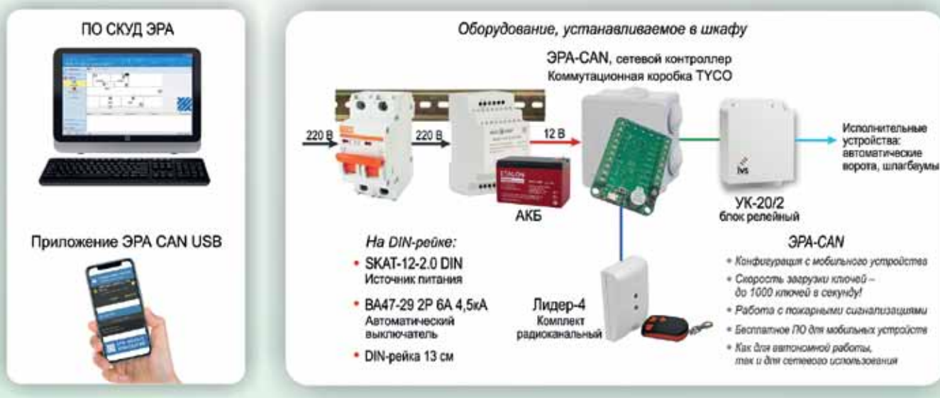
Рис. 3. Схема построения системы контроля доступа
