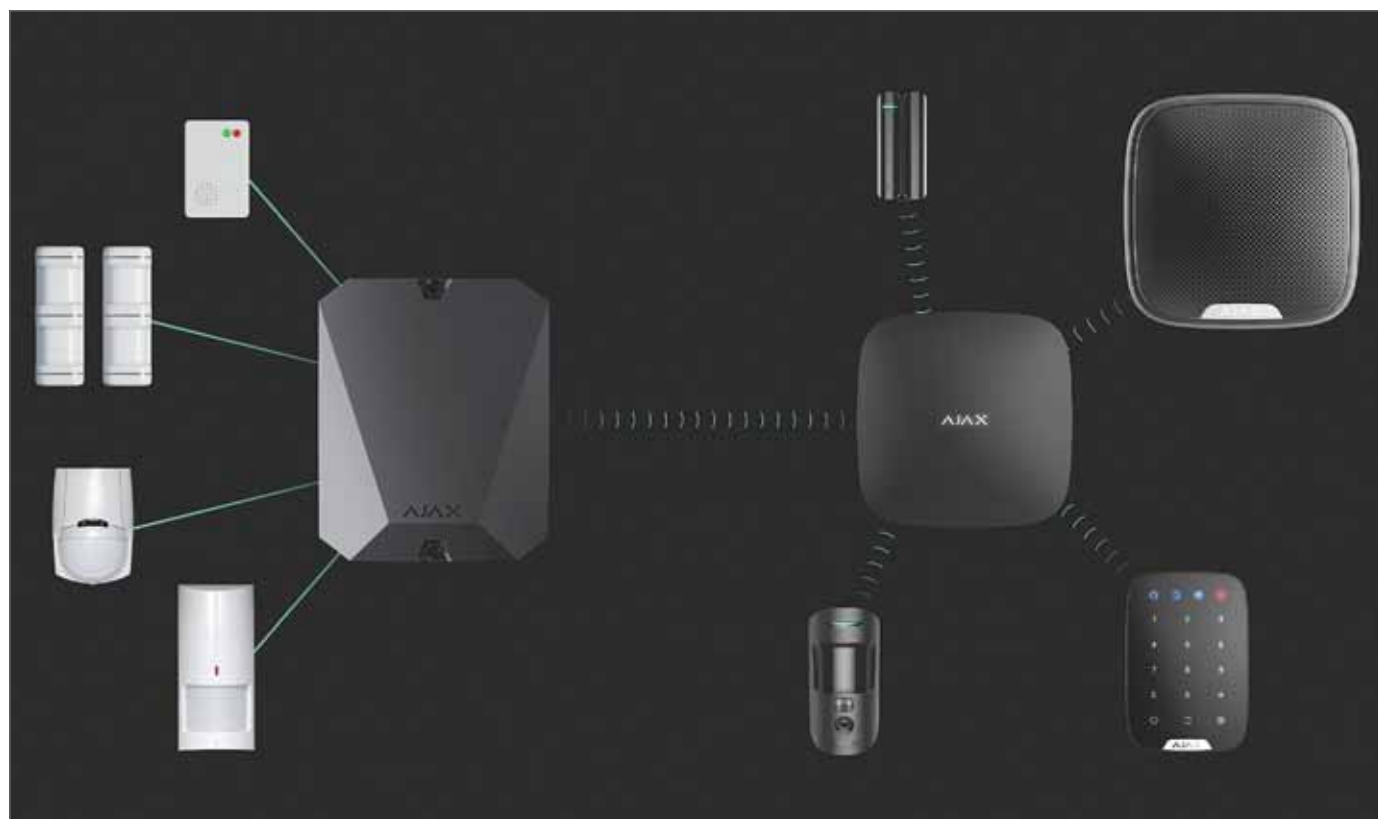
MultiTransmitter подключает проводные устройства к хабу по радиосвязи Jeweller
