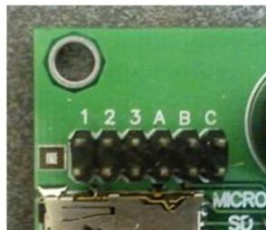
Рис. 5.1. Перемычки на NV DG/DT 2010
