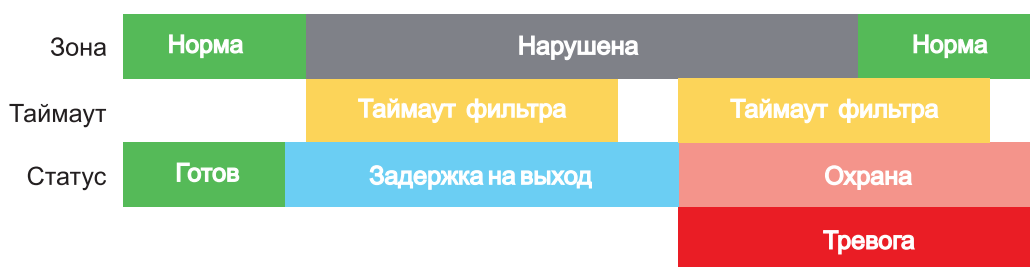
Рисунок 12. Нарушение зоны в момент постановки на охрану.
