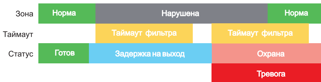
Рисунок 12. Нарушение зоны в момент постановки на охрану.
