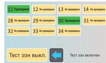
Режим «тест зон» предназначен для удобной проверки и отображения работоспособности системы. При включении режима и выполнении прохода под извещателями на экране отображаются проверенные шлейфы сигнализации. Тест зон очень удобен при пусконаладочных работах, монтаже и обслуживании систем с большим количеством шлейфов.
