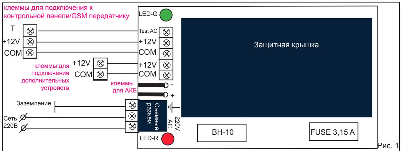
Клемма для подключения входного напряжения 220В и заземления является съемной.
