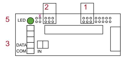
На плате контроллера находятся две группы перемычек 1 и 2, клеммы для подключения к контрольной панели 3, разъем для подключения к NAVIgard 2050 4 и светодиод 5.
