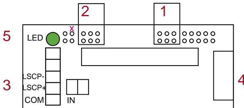
На плате контроллера находятся две группы перемычек 1 и 2, клеммы для подключения к контрольной панели 3, разъем для подключения к NAVIgard 2050 4 и светодиод 5.
