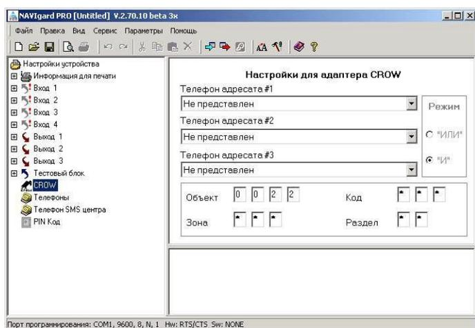
Перед началом работы необходимо запрограммировать GSM передатчик NAVIgard 2050 с помощью программы NAVIgardPRO (см. инструкцию по эксплуатации на NAVIgard 2050). Выбрав в левой части окна пункт "Внешняя контрольная панель" введите номер объекта и телефон мониторингового приемника. Информация о коде, зоне и разделе поступает с контрольной панели.
